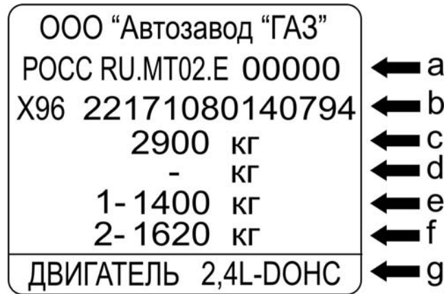
Рис. 1.3. Пример заводской таблички с паспортными данными автомобиля ГАЗ-22171 с двигателем CHRYSLER 2,4L-DOHC
